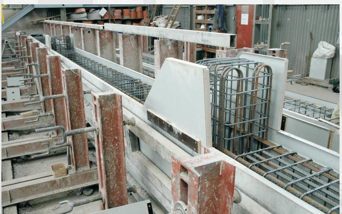
Výroba prefabrikátů převážně probíhá v modernizovaných a rozšířených výrobních prostorách. Při výrobě dílců je používána univerzální formovací technika, samozřejmostí je provedení prvků se všemi hrany zkosenými, horní plocha je strojně hladěná. Příprava armokošů probíhá na třmínkovačkách značky STEMA. Jen malá část produkce je nakupována u jiných výrobců.
